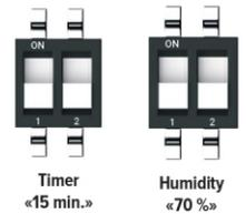
Ventilátor sa automaticky zapne, keď zabudovaný snímač vlhkosti zistí prekročenie 70 % (pozri **ODDIEL 1**), a bude pracovať, kým snímač vlhkosti nezistí pokles na 70 % alebo nižšie (pozri **ODDIEL 1**). Ventilátor potom pobeží 15 minút (pozri **ODDIEL 2**) a vypne sa.
