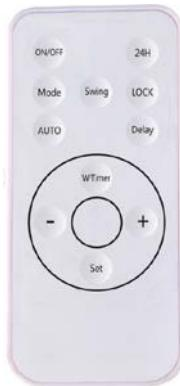
1. "ON/OFF" Hlavní tlačítko napájení
